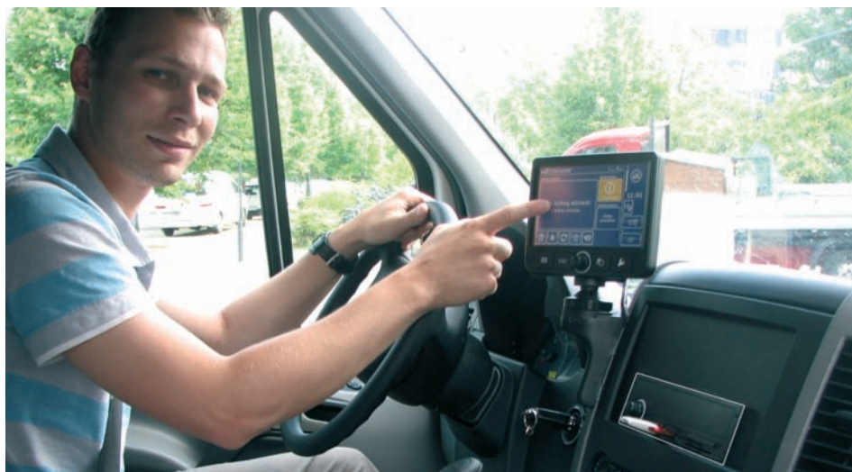
Grundgerät mit USB-Stick und Touchscreen im Messfahrzeug
