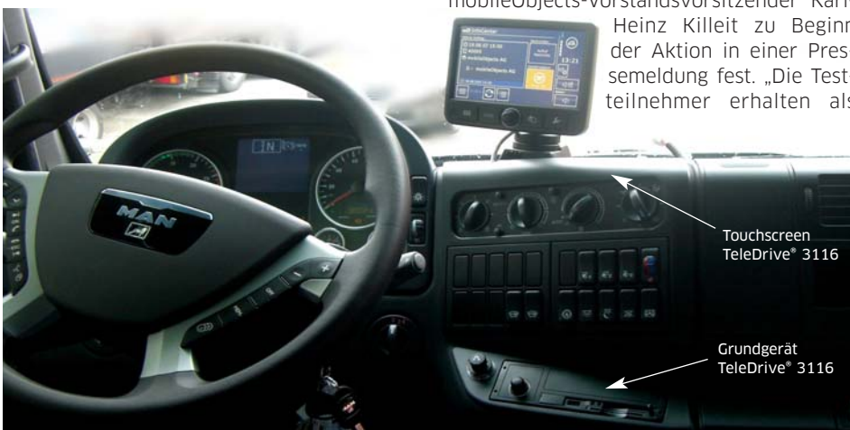
Anpassungsfähig: So sieht der Fahrer TeleDrive® 3116 im Lkw-Cockpit
